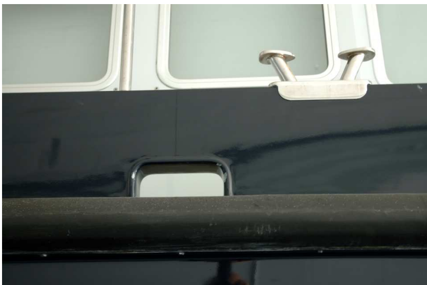
Klampe, Trossendurchführung ( Speigatt ) und Scheuerleiste
